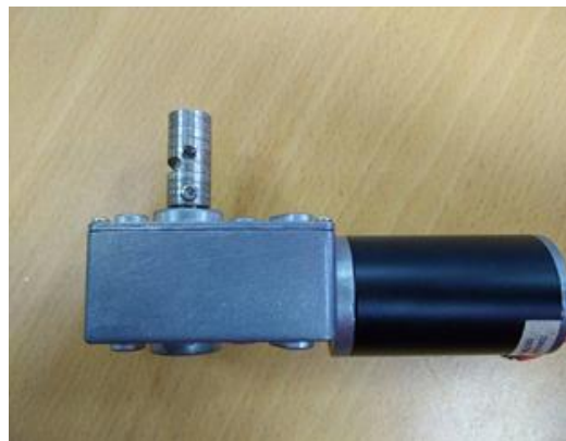
套筒固定在馬達軸心
