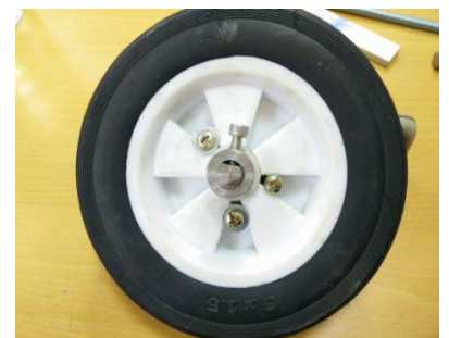
軸心放入以套筒固定
