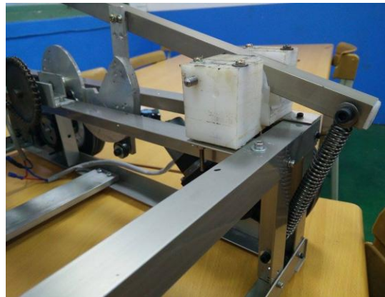
下壓後彈簧被拉長，等圓盤壓至極限從桿子上鬆脫後，彈簧會彈回原來的位置，利用其彈性將球彈出
