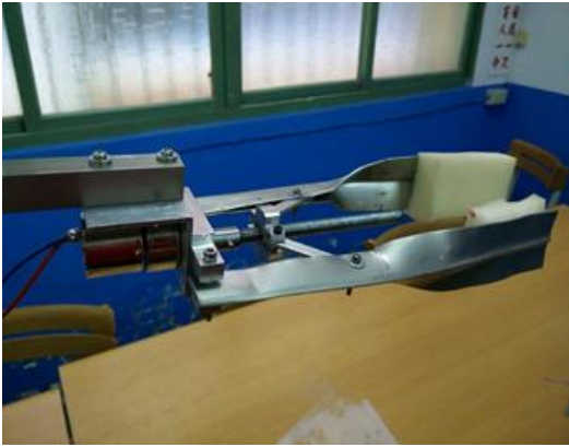
將夾爪機構固定在鋁條上
