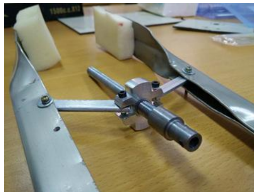
將圓盤轉入螺桿內，套筒鎖在螺桿上，兩側連桿各固定於圓盤和夾爪
