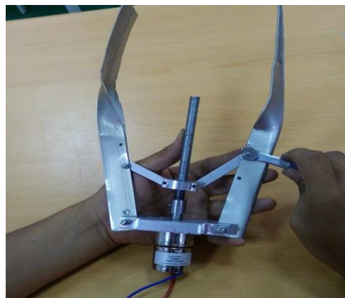
將套筒固定在馬達心軸上
