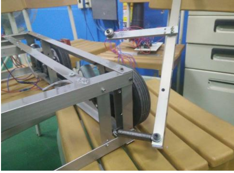
將彈簧固定在機架上且將軸承固定在鋁條上而鋁條則固定於桿子上
