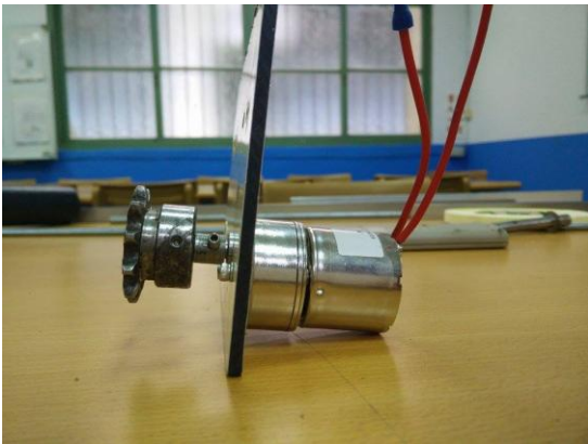
將馬達固定於板子上，齒輪 (12 齒) 固定在馬達軸心前端
