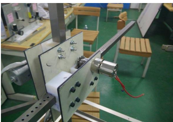
將齒條插入兩塊塑膠塊的凹槽中，讓齒輪與齒條上的洞咬合
