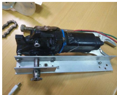
馬達固定於角鋁上且齒輪固定在馬達軸心
