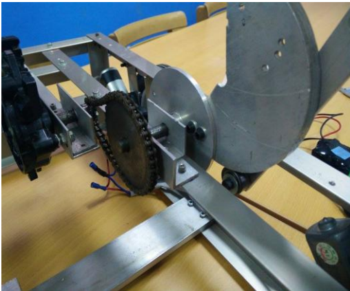
馬達轉動以鏈條帶動圓盤組上的齒輪讓圓盤轉動將桿子下壓
