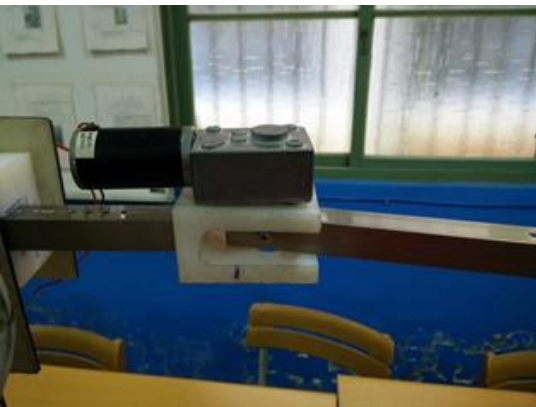
組裝完成，將機構固定於齒條上
