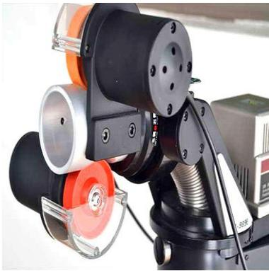
2. 參考乒乓球發球機，利用兩轉動的飛輪，夾擠球，給予籃球一初速度飛出，且在多裝上一根管子控制球前進的方向，此種機構穩定且易控制。但我們考慮到玩具籃球較乒乓球而言更軟，當飛輪壓縮時可能會導致不可預期的結果，因此放棄使用。
