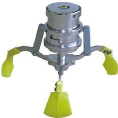
1. 由於籃球為球狀體，因此可利用三點就將其夾起，所以我們參考了夜市常見的夾娃娃機，利用他夾爪的構造來達到取球的目的，而且他的構造更能與我們一開始的想法：利用機器手臂寫字，兩者能夠合而為一，只利用一隻手臂就能完成任務。且為了防止球會滑落，因此夾爪上會加上能夠增加摩擦力的構造，像是止滑墊等，加強夾爪得抓力。
