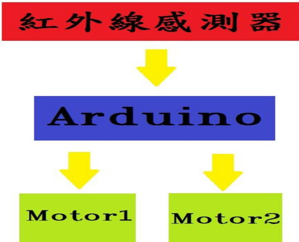
利用紅外線感測器去感測車體與黑線上的位置，根據不同的狀況，輸入不同的誤差，讓arduino控制器輸出不同的電壓驅動馬達，改變左右馬達的轉速以校正中間感測器偏移的量，使中間感測器可以保持於黑線中央。
