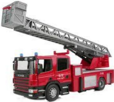
1. 參考雲梯車，由於規則中僅限定不能觸碰到籃框，因此直接利用雲梯車構造，將球移動至籃框上方後將之放入成為最簡單之方法。但製作時發現伸長的機構容易垂下變形，增加觸碰到籃框的風險，因此最後將其放棄不用。
