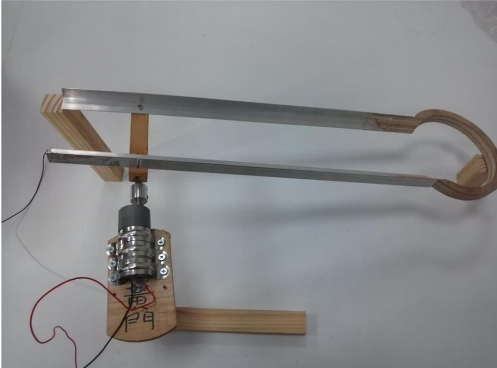
簡單的構造可以達到投球的目的，圓形處為置放球的位置。
