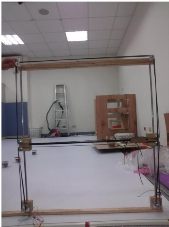
下方兩點為步進馬達裝置處，並以皮帶輪帶動皮帶（黑色條狀物即為皮帶）。中間部分有皮帶可以帶動中間置筆處上下移動（圖中不太清楚，位於靠近右方中間木塊處）。
