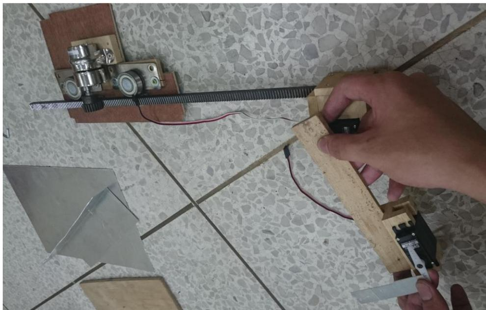
4. 夾球: 夾球機構由於投石機構變高，導致發射點比原本撈球(夾球)的地方還高，於是我們就換了一個設計，一邊夾爪固定，另一邊夾爪可以對 z 軸做旋轉將球夾住或放開，再將這兩片夾爪連上兩個伺服馬達(一個伺服馬達力不太夠)，並可以對 x 軸做旋轉，使他可以將球放到更高的點，如下圖所示。
