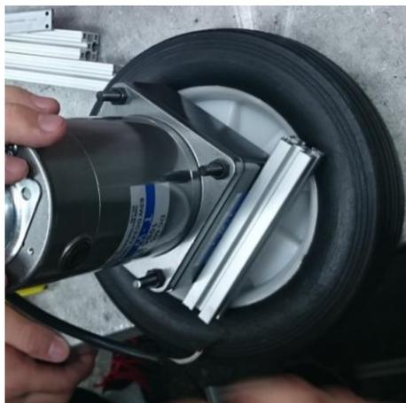
先在鋁塊上銑出一個導軌，讓鋁擠型的凹槽可以放進去，使鋁擠型只能做一個軸向的移動，再在鋁擠型的4個點鑽孔並鎖上螺絲螺帽，在將這四組螺絲螺帽套上馬達，這樣就固定馬達的一個邊了。
