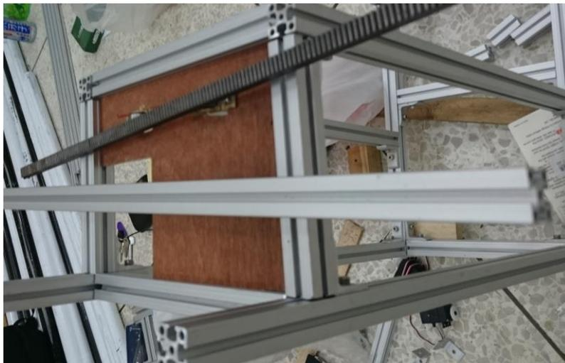
因為會左右晃動，所以又裝了四個軸承來限制他左右的移動，再用馬達帶動齒輪，齒輪帶動齒條使抄球機構可以達到第一個方向的移動。
