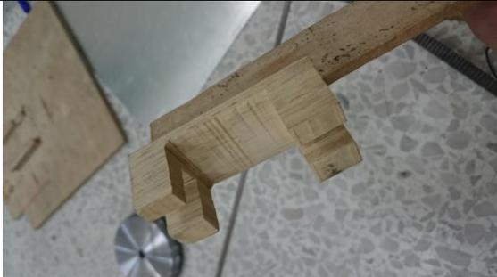
因為伺服馬達不能直接所在鋁擠型上面所以我們決定用木頭來將伺服馬達固定在鋁擠型上面。先用鋸床將木塊鋸成這樣
