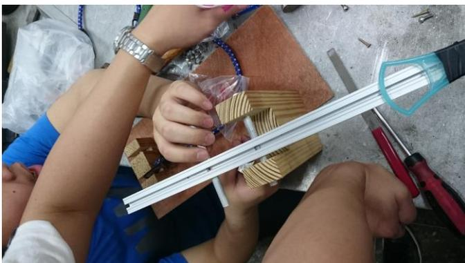
首先我們用一塊木頭當作投球機構的支架，然後拿鋁擠型當作投球桿並在桿的末端裝了網子用來裝球。再將木頭和鋁擠型的中間鑽孔並塞入一鋁條使投球桿可以上下轉動。
