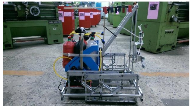
(圖二)側視圖：由上圖可知機身重心較低，行走較為平穩。
