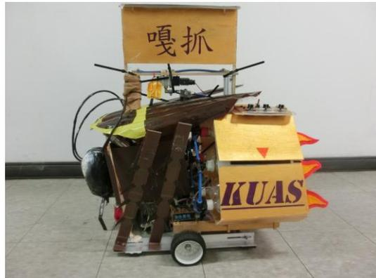
右側視圖：主動輪來輸出動力使機器人移動，前跳氣壓缸與直跳氣壓缸與頂球裝置(可以順便打廣告)、防塵蟑螂身體與腳。
