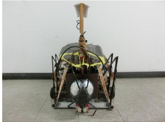
正視圖：前方有一組導輪以防止機器人傾斜，以及感測器至於導輪後方，蟑螂頭與身體。
