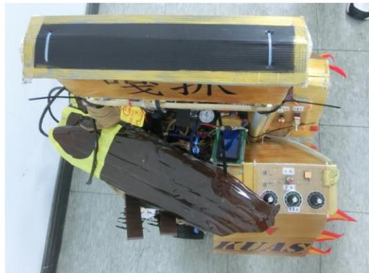
俯視圖：控制板、LCD 面板、電源開關、CSL 自製馬達驅動器、電磁閥、蟑螂翅膀。
