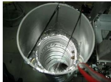
圖五 取球機構
