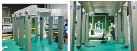
採用八點著地的底盤機構
