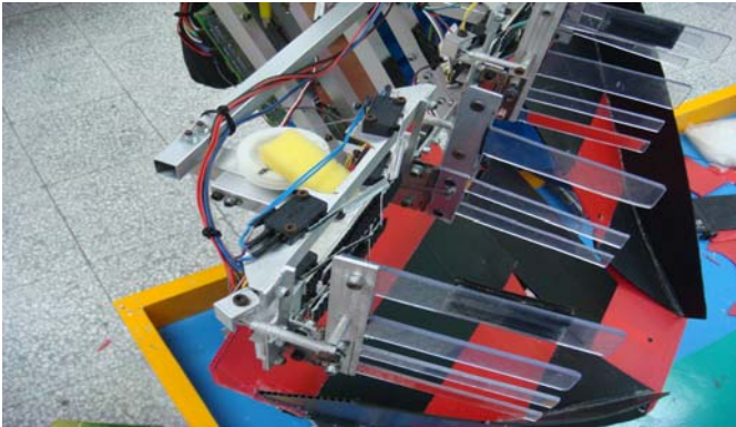
圖 3：當機器人行走到定位，手臂伸出那時候張開夾爪
