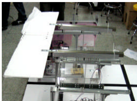
圖 4. 實際所完成的取物機構圖
