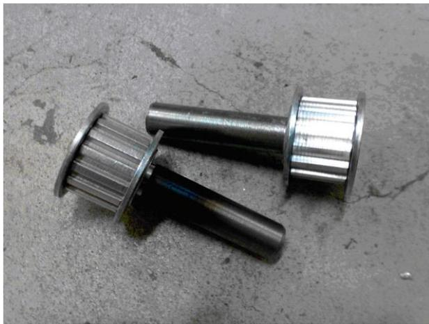
圖五 前輪軸貫穿皮帶輪
