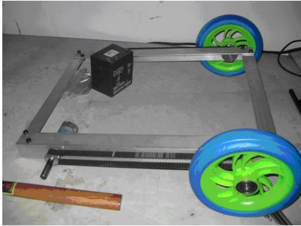
圖四 四片 L 型角鋁所組成的底部
