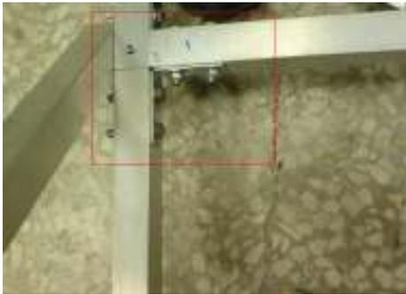
機器人的輪胎，是放置在機身左右兩邊，共四顆輪子，將底盤鋁條，左右各鑽兩個洞，在輪子中央鑽一個洞，再用一根螺紋棒當作輪胎軸，將輪胎加上齒輪，再將左右各鎖上兩顆螺帽，這樣可以把輪胎固定住，使輪胎可以空轉，又不會卡死。
