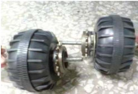
然後將輪胎軸穿過輪胎跟底盤，然後用螺帽鎖緊，然後將馬達固定在左右兩顆輪胎的中間，然後使用鏈條，將前後輪跟馬達連接起來，使馬達可以帶動前後輪，讓機器人可以前進後退。
