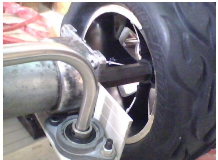
六角柱輪柱、輪胎與馬達軸心實際組合圖
