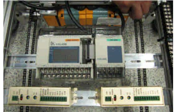
圖 8 PLC 與直流無碳刷馬達速度控制器
