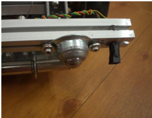
圖(九)前端最左邊感測器
