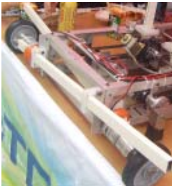
升降機構：製作齒輪桿，用電動窗馬達帶動齒輪，使齒輪桿上升下降。
