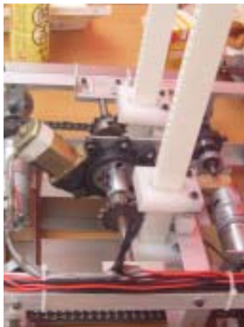
升降機構：製作齒輪桿，用電動窗馬達帶動齒輪，使齒輪桿上升下降。
