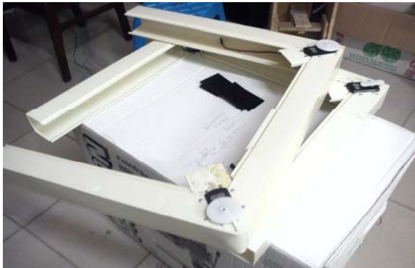
↑馬達均固定在機身的對角線上，有平衡的效果。
