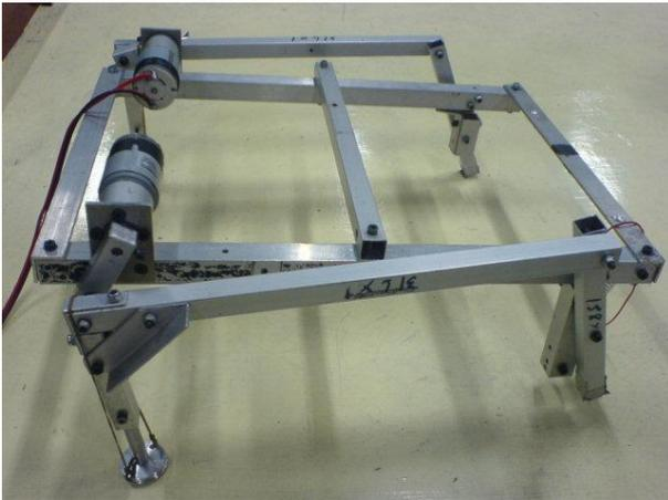
圖二：足步機構測試機
