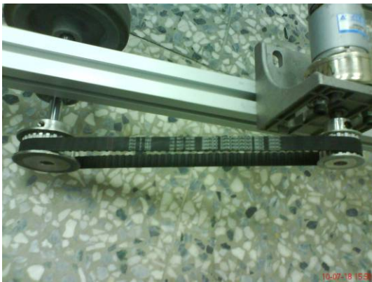
圖三、採用 DC 12V 200RPM 馬達，設為前輪驅
