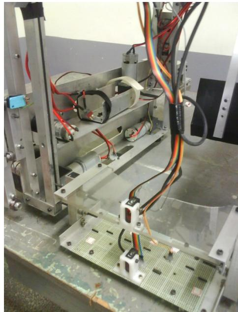
圖 9：感測器升降側邊溝槽
