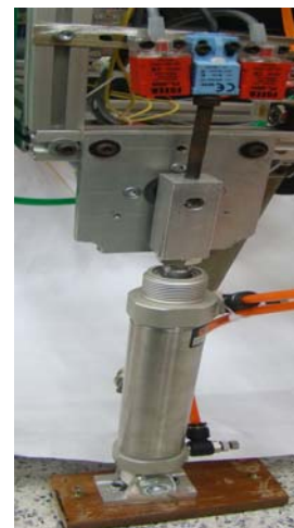
圖二 機器人的腳與腳擺動極限之近接感測器
