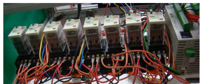
圖七 台達的可程式控制器與可手動驅動之繼電器配線
