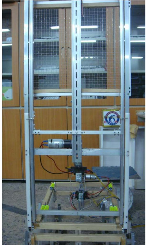
滑軌下方放置「勝利之鑰」後起動連動系統使上方的取球裝置上升到定位，以馬達旋轉兩片 pp 板迅速錯位將羽球夾起，在使滑軌回復閉鎖裝置，同時開啟截集球裝置。
