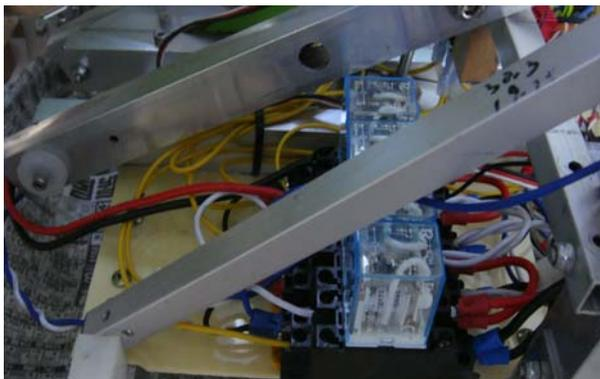
這部分繼電器是用來控制擊球網機構、撥桿回復機構、小馬達開關、取羽毛球機構小馬達正逆轉、滑軌上升下降...
