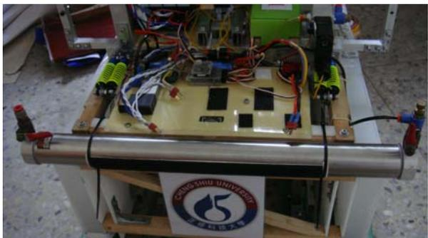
這是機器人的電路配置圖黑色的部分是黏著三個鋰電池還有最重要的氣壓缸鋼瓶的放置、放在後面的目的是為了配重。
