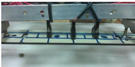
綠豆沙一號行走方式是用 PLC 傳輸訊號到 4 顆馬達來帶動 4 個輪子，在尋線功能用紅外線感測器來感測黑線以完成行走功能，夾爪機構主要用來夾住娃娃，排除木箱障礙是仿推高機方式使把木箱搬運到指定地點放置，土石流區需有避障之功能，所以使用光纖感測器來達成避障之功能
