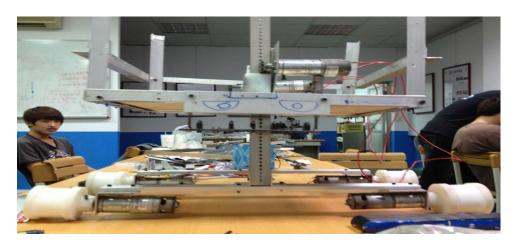
機器人的高度有超過 40CM,所以當機器人的輪子接觸到階梯時,不用任何的升舉機構來把機器人抬高,前面有個舉重物的平台,可以先利用平台來輔助機器人上階層,也可以舉起重物來排除障礙。
