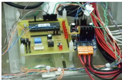
圖五、dsPIC 晶片以及馬達驅動 IC
