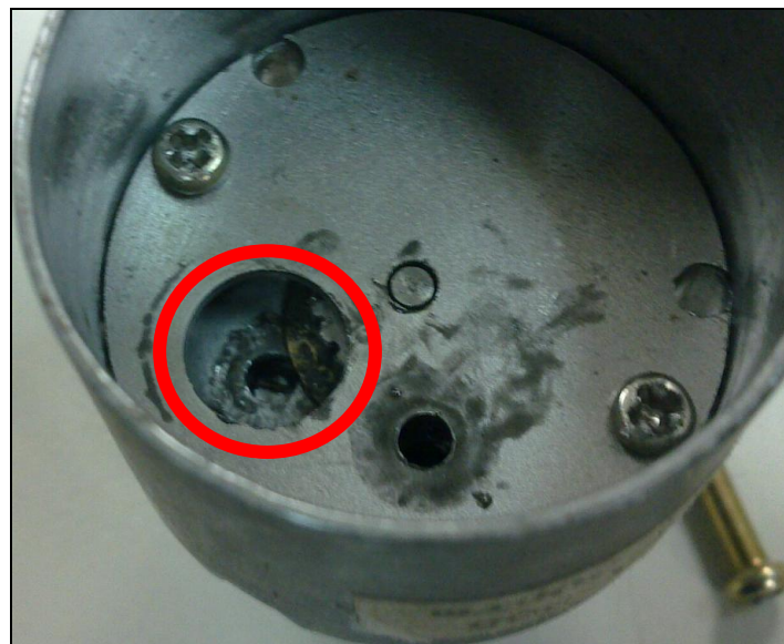
圖十四、紅圈內為齒輪經過使用後磨損
