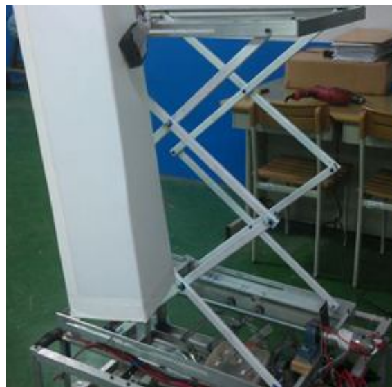
圖 6 利用升降機構將吊籃上升某一高度
