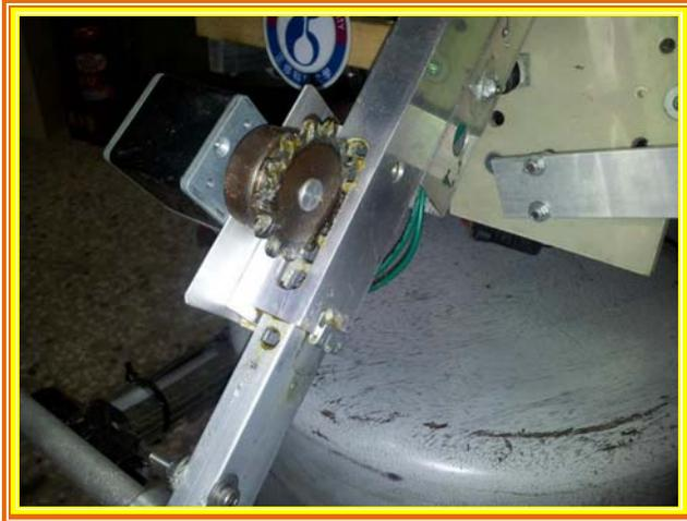
我們將升降機構與伸縮機構組合之後發現超過比賽規定機器人出發前的尺寸，因此我們在兩機構之組合處以一根軸作暫時的組合，比賽開始後不限定尺寸，我們就用升降機構降到底，使之觸動位於伸縮機構上之彈簧插銷，利用插銷與升降機構之圓孔配合，隨後舉起；
