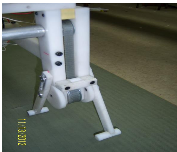
圖-15.4 新設計的腳步機構實作成品
