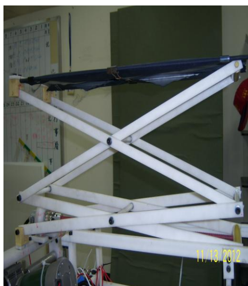
圖-7，升降機構最低狀態
