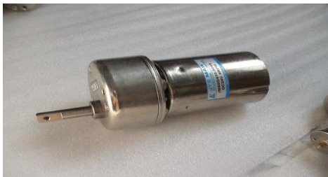
圖-11.3 前腳旋轉與手部馬達(M3)
