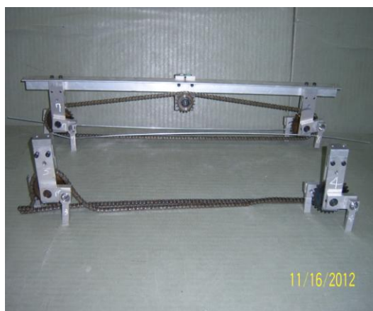
圖-15.2 實際機構-腳步機構製作成品
