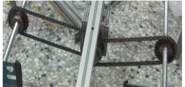
(圖一)傳動軸設計概念，中間馬達做為共通傳動軸，帶動我們的傳動軸，直接傳動減少功率耗損。
