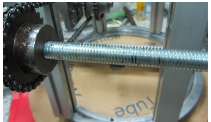
(圖二)傳動軸我們選用 4" (4 分) 螺桿做為傳動軸，彈性應力相當不錯，被齒條強力拉動，變形幅度甚小，傳動也十分順暢。
