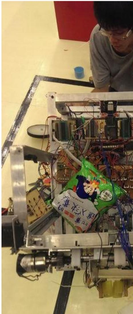
說明：使用塑鋼製夾爪，輕巧又兼具強健性。
