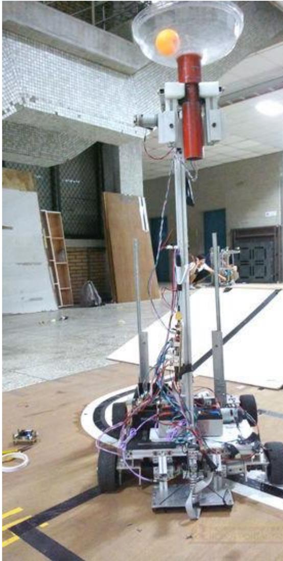
說明：使用鋁擠型，讓整體結構穩固、乾淨俐落。
