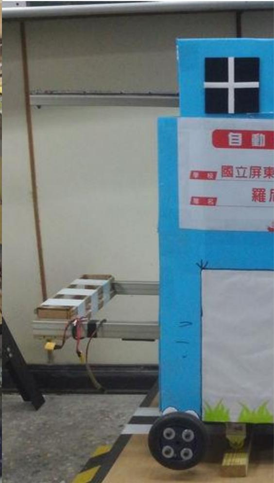
說明：左右大致上對稱的的設計，可以讓四顆動力輪平均分配整體機器人的重量，使機器人行走上可以更加平穩。
