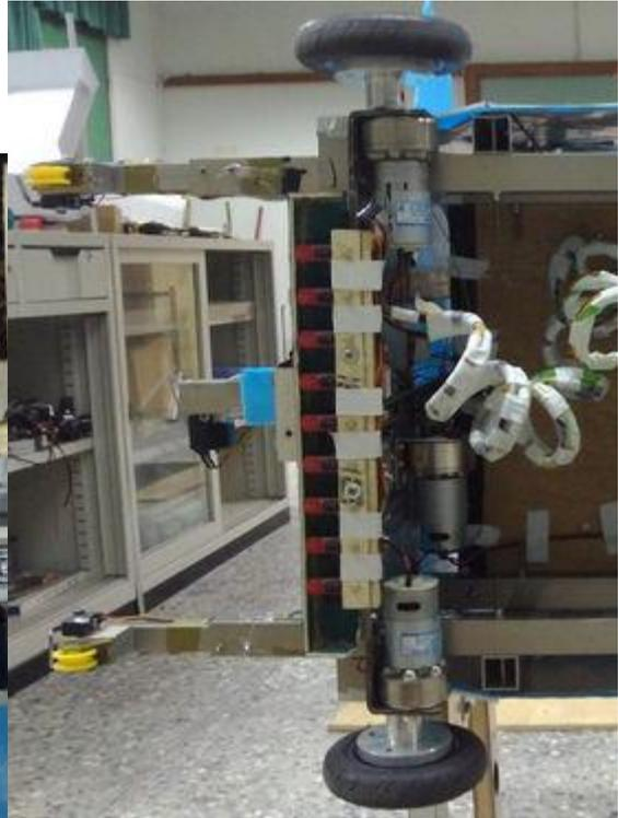
說明：四點著地的輪型機器人，每個動力輪皆由高扭力直流馬達趨動，搭配四顆單向輔助輪來通過關卡。
