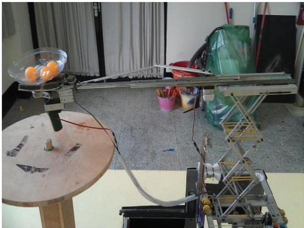
馬卡道路:左右支撐桿撐在馬卡道路上，前半部機構上升，後輪推動往前走，直到光電開關測到指定距離後停止。
