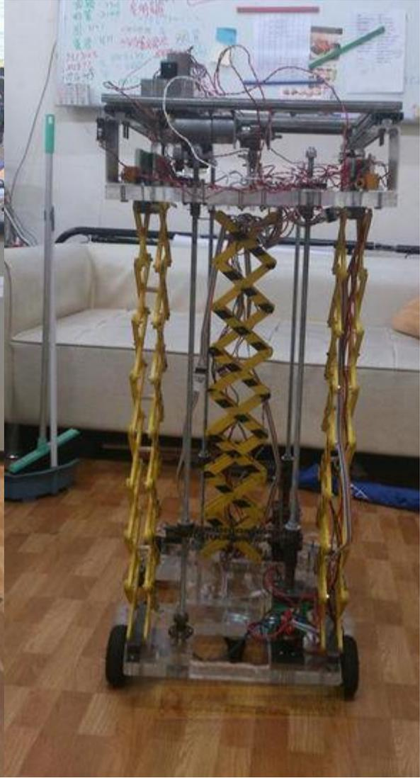
說明：圖為伸展後的模樣，4 面為支撐用的剪式機構。
