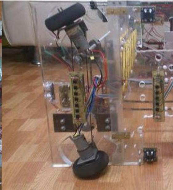
說明：車輪、驅動馬達和追線電路。
