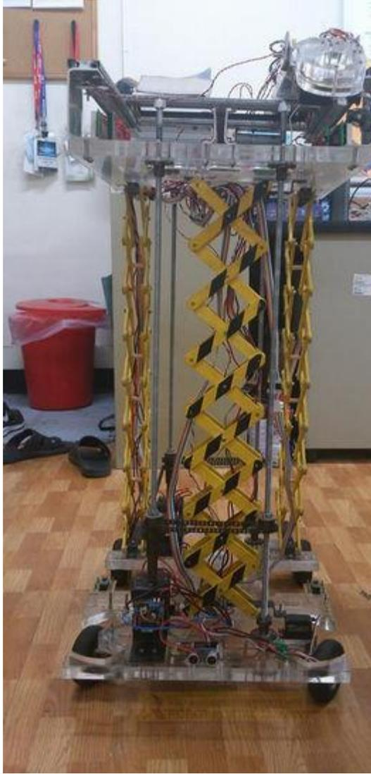
說明：圖為伸展後的模樣，4 面為支撐用的剪式機構。
