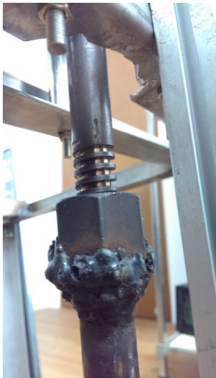
圖一、螺帽與不銹鋼管的電弧焊。
