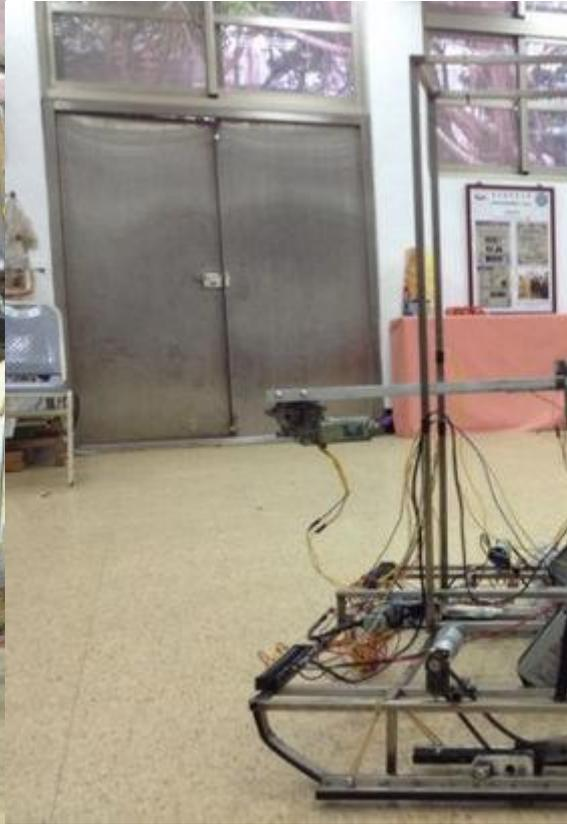
說明：機器人整體以不鏽鋼焊接而成，我們是考慮到必須以強度夠又輕巧，能在比賽前過磅時可以90度的方式插進指定的位置，所以我們最輕的重量來過關，而在走半屏山時也做了一個能夠使夾爪90度擺動的機能防止不倒，最主要就是能再行走方面構，這有點像釣竿一樣利用後方馬達捲動鐵線來使前方夾爪能夠上下擺動。
