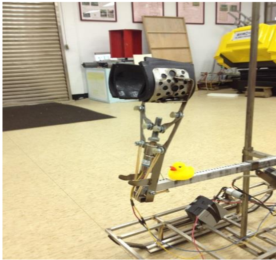
圖 8 機器人夾爪機構
