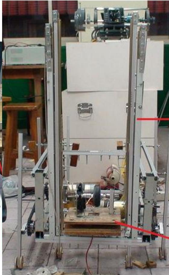
說明：(1) 機械夾爪：兩個反方向的伺服馬達完成夾物品的動作，重量輕及夾緊力量足以應付任務。(2) 夾爪旋轉機構：一只伺服馬達完成夾爪旋轉任務，新是將伺服馬達軸心及塑膠轉臂皆鑽孔，再以不銹鋼私固定之，避免塑膠轉臂滑牙。(3) 手臂之前進及後退機構：由汽車電動動窗馬達及滑軌組成，扭力所產生的磨擦力，足以推動手臂之前進及後退任務。
