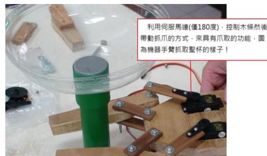
圖 2. 尚未刨夾爪弧度及黏上橡皮前的機器手臂前端夾爪
