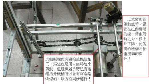
圖 10. 機器手臂及與抬重物機構之拉線上升及下降的馬達架法
