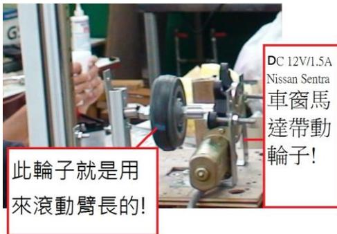
圖 4. 機械手臂伸縮功能之馬達及輪子架設
