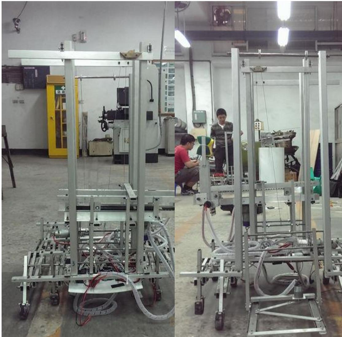
說明：正面的手臂以側放方式裝配在夾聖杯和插銷時可不必轉動 整隻手臂。手臂以齒條前後伸縮。手臂可以上翻，將柱狀物放置於皮帶上，一次夾取和放置所有柱狀物。
