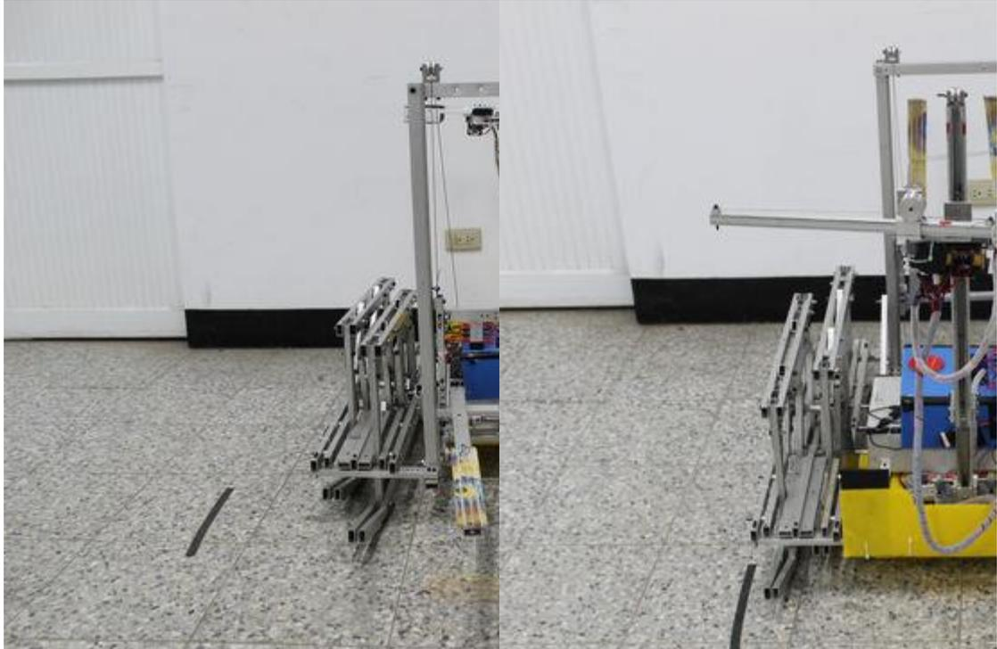
說明：靈感取自堆高機，同樣使用捲線器拉動滑塊方式升降，滑軌採用一般裝潢使用的鋁型材及培林輪組合，減少不必要的力矩，使驅動設計較為簡便。
