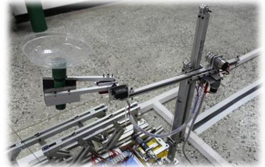
(圖十二)機器人所使用的圓柱座標式手臂
