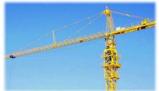
(圖十三)上半部手臂與吊臂外型相似，並且具有水平移動及 270 度的旋轉功能
