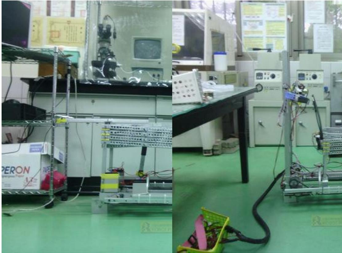
說明：前端升降系統底下利用鋁管配合齒輪讓整體升降機關可做前後運動，並妥善利用底部空間將電池置於側面。
