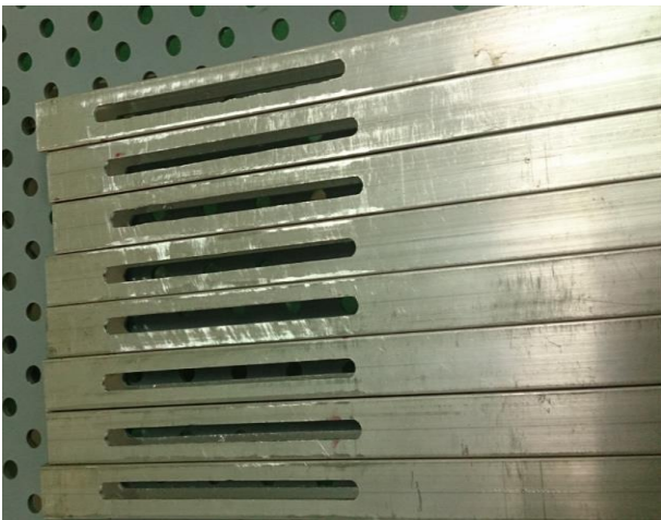
圖 6 機器人滑槽支架
