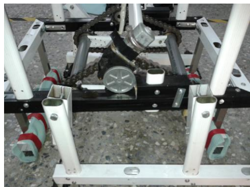
(透過兩個點來支撐，來使腳能夠穩定平直的移動)
