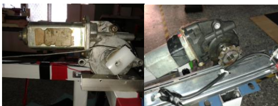
(左圖為馬達拉線上升 右圖為齒輪直接帶動)
