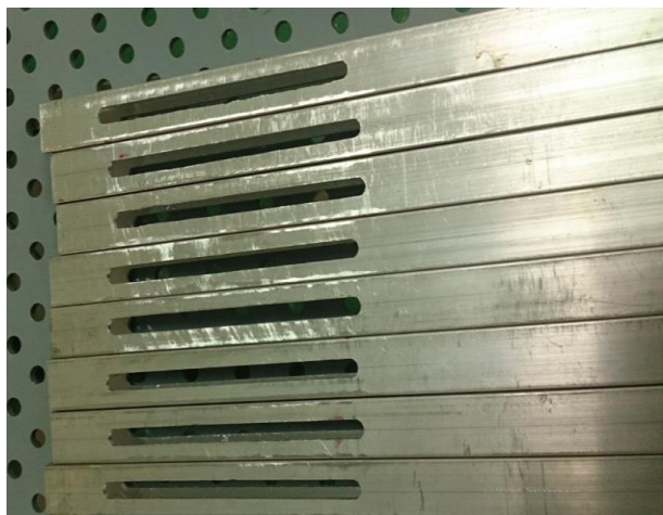
圖 6 機器人滑槽支架
