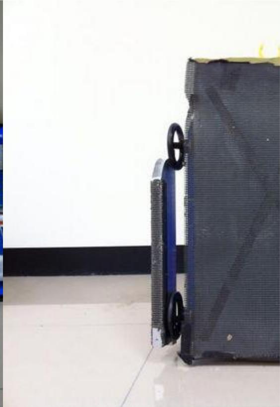
說明：足部機構採用一根連桿強制同步前後馬達帶動，前方裝設類似雪橇，較易通過障礙。
