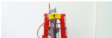
機器人前端以馬達來拉簡便的夾子，使之打開和關，夾取聖杯。
