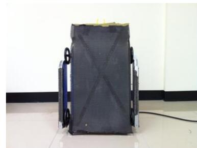
足部機構採用一根連桿強制同步前後馬達帶動，前方裝設類似雪橇，較易通過障礙。
