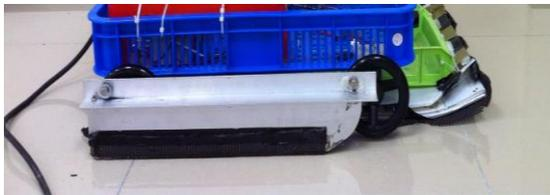
馬達使用小型，減少本體負重，足部使用一根連桿強制同步前後馬達帶動，前方裝設類似雪橇，較易通過障礙。
