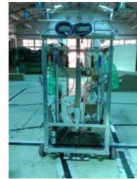
這是正視圖部份，最下方就是感測器來感測黑線來行走關卡路線，最上方就是爪子，爪子接下來的管線就是氣壓缸的配線，以及伸縮桿裝置，來夾取物品。
