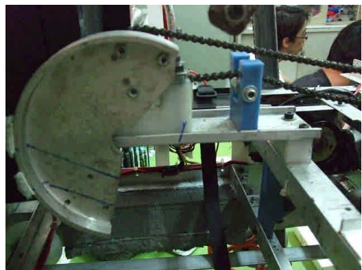
9. 擊球機構：使用偏新倫的方式將擊球桿及彈簧的配合拉至一定的彈簧極限，偏心輪轉動到達到一個定點將硬力釋放，使得球更加精準及射程穩定。還要配合馬達的減速更加極致。
