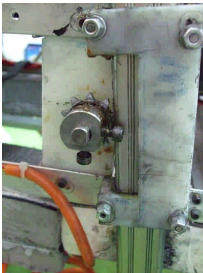
7. 輪軸：本組成員自製，經過老師指導，於輪軸處進行圓角加工。與歷屆學長加工之直角有所不同。
